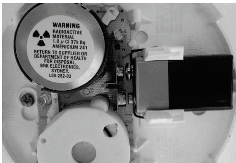
Abbildung 1: Inneres eines Ionisationsbrandmelders <sup>[1]</sup>
